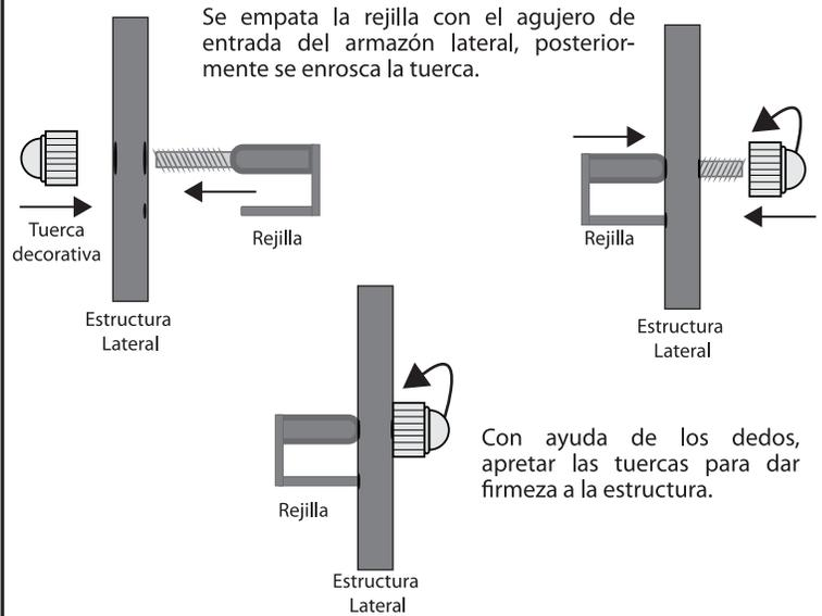
Se empata la rejilla con el agujero de entrada del armazón lateral, posteriormente se enrosca la tuerca.
